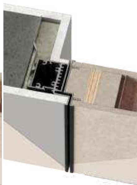
Ultimatum Схема-разрез реверсивного открывания для дверного полотна 59 мм
