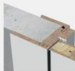
Пример монтажа коробки с дверью прямого открывания
